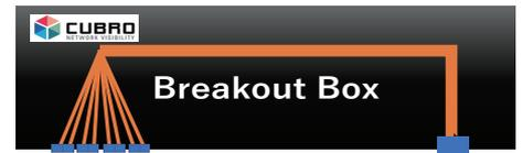
QSFP用のブレイクアウトケーブル（MTP x1 ⇔ LC x8）は、40G/100Gから10G/25G x 4chへのライン分割時に利用されています。しかし、コネクタベースで1対8の形状となるこの光ケーブルは、誤配線をはじめとする接続に関する様々な問題を引き起こします。
